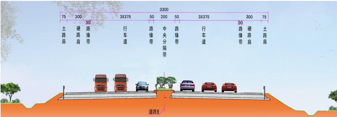
图 3.2-2 洪张线到—S341 省道段路基标准横断面图
