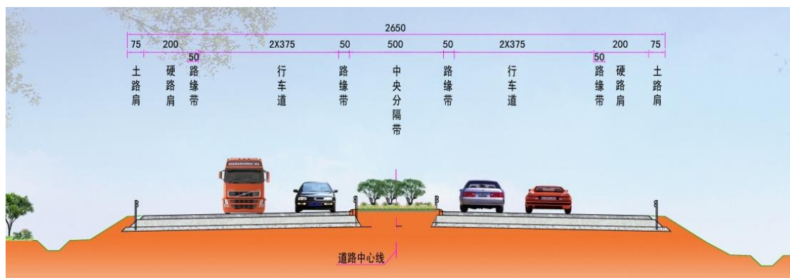
图 3.2-16 现状乌刹桥—柘塘段公路横断面图
